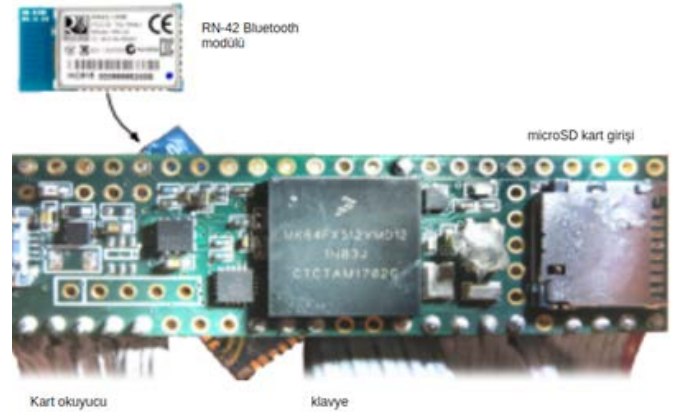
Şekil 78: Kaliforniya'daki benzin istasyonunda Bluetana tarafından yakalanan Bluetooth tabanlı bir "Skimmer" cihazı [17] .
