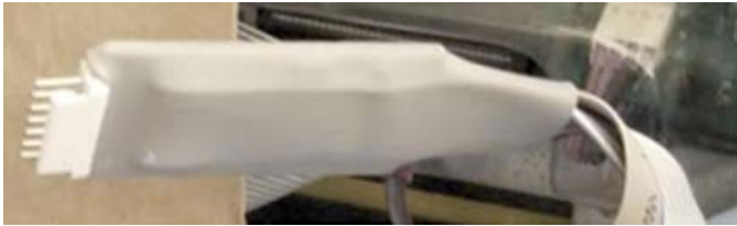
Şekil 77: Yakıt pompasındaki kablolarla uyum sağlayan gri kablolu dahili Bluetooth tabanlı "Skimmer" cihazı [17] .
