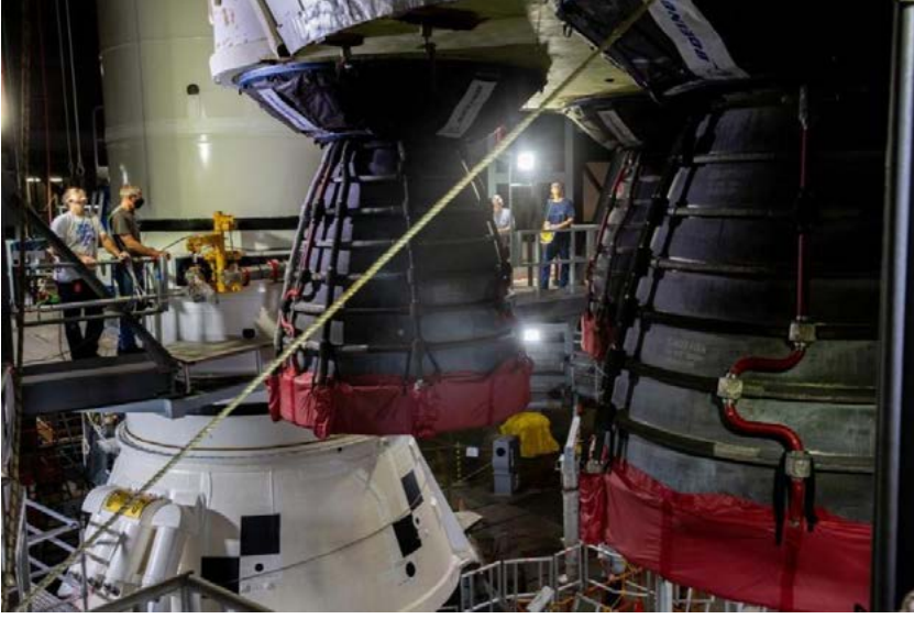
Şekil 2: NASA'nın SLS sistemi için testleri yapılan RS-25 motoru 4 .
